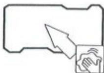
b) Applicare il nastro biadesivo posteriormente allo strumento
